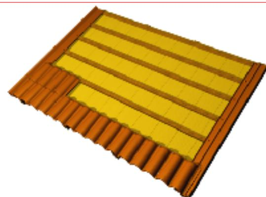
Posizionare il primo elemento **Bricoppo** della seconda fila poggiandolo in corrispondenza dell'elemento inferiore e facendolo scorrere verso il basso fino a bloccare i ganci sotto il culmine dei coppi del primo elemento della fila precedente. Procedere quindi al fissaggio solo sulle asole superiori dell'elemento.
