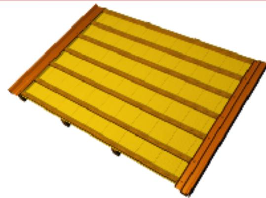
La listellatura per il sostegno e fissaggio degli elementi **Bricoppo** può essere realizzata con listelli in legno (30 x 40 mm), posizionati orizzontalmente con un interasse fisso di 333 mm (meno i primi due listelli a valle, che avranno un interasse di 302 mm).
