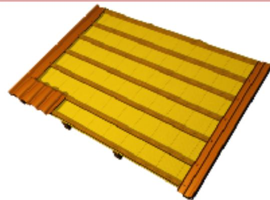
Posizionare il primo elemento **Bricoppo** in basso a sinistra, curando particolarmente l'allineamento orizzontale con il primo listello e posizionando il **Bricoppo** con 50 mm di sporgenza sul primo listello.
