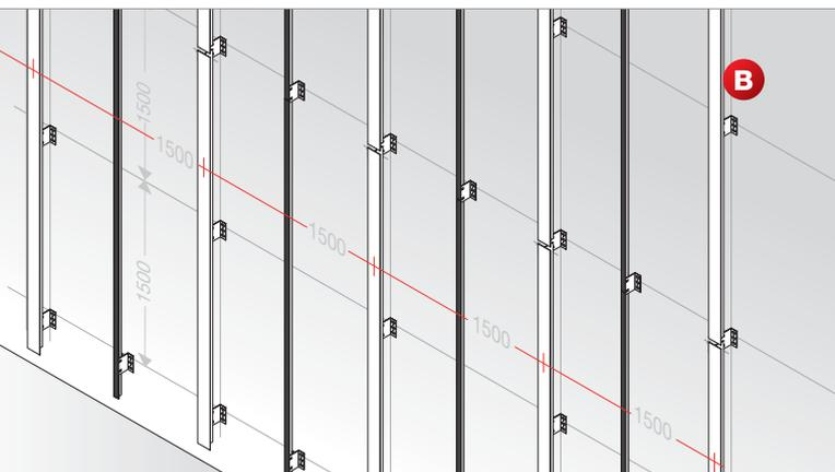
Per evitare disallineamenti verticali della struttura che potrebbero causare problemi nel montaggio delle lastre, è opportuno utilizzare una staffa di collegamento (vedi anche tav. a pag. 37) fra il montante inferiore e quello superiore. In particolare, fissando i due montanti sulle due asole per il fissaggio scorrevole di una stessa staffa si garantisce la perfetta continuità geometrica del montante e contemporaneamente la libertà di dilatazione lineare necessaria.
