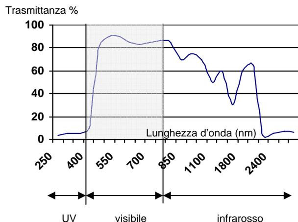
La risposta allo spettro della radiazione solare evidenzia come una lastra in policarbonato protetto UV, schermi quasi completamente la componente ultravioletta (solo il 4% in media della radiazione compresa fra 250-380 nanometri filtra attraverso la lastra), e rimanga trasparente rispetto alla componente del visibile.
