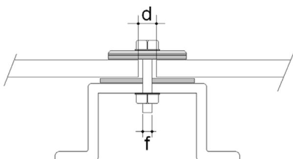
Eeguire il foro sulla lastra maggiorato del valore previsto di dilatazione termica, pulendo scrupolosamente il foro da ogni residuo di lavorazione.
