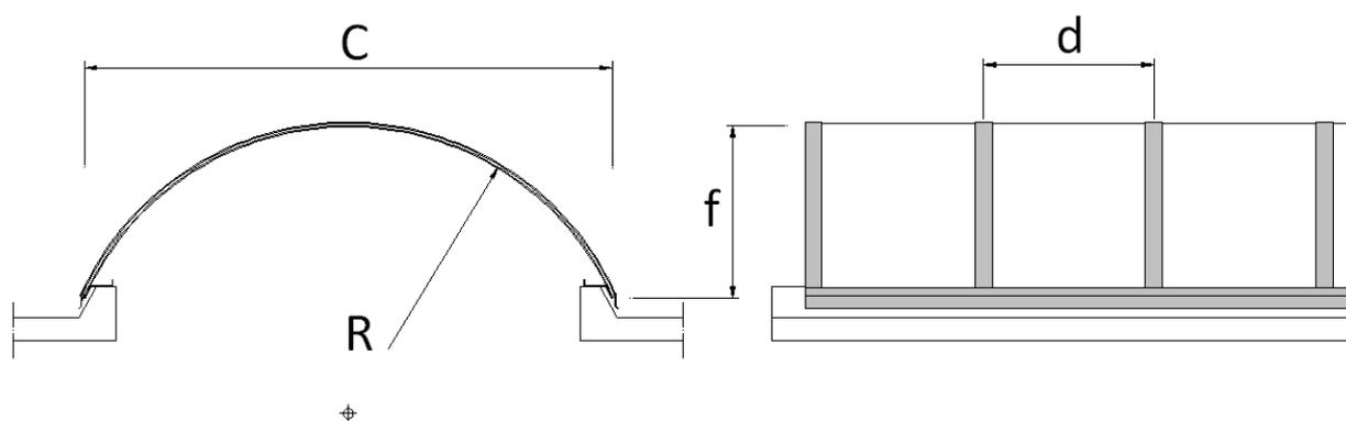
Il parametro di progetto è la larghezza della lastra, le tabelle riportano lo spessore minimo utilizzabile della lastra in funzione l'interasse dei profili di supporto e del raggio di curvatura.
