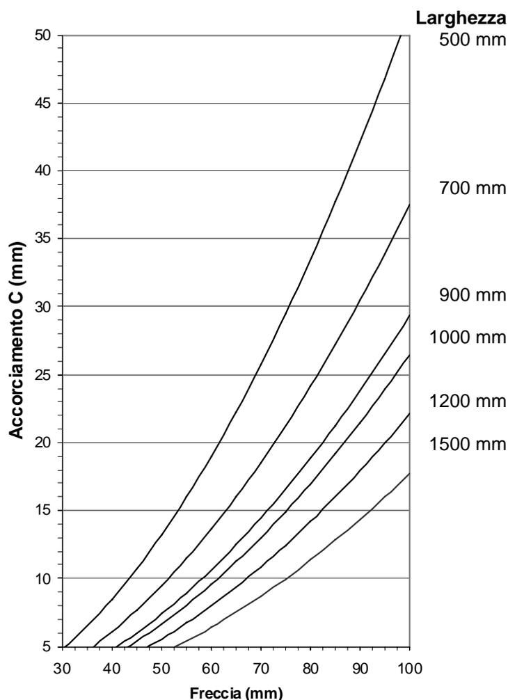
Il diagramma permette di calcolare l'accorciamento virtuale della larghezza, conoscendo la freccia di deformazione.
